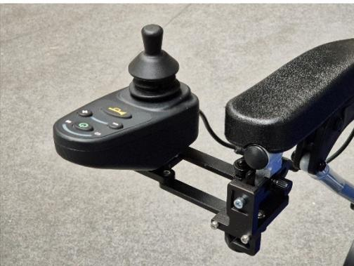
Schwenken Sie das Fahrpult in die Position, die Sie bevorzugen und fixieren Sie das Fahrpult wieder mit der Fixierschraube.
