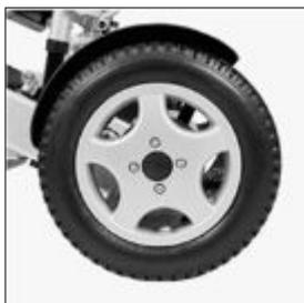
Für unebenes Gelände und mehr Komfort, da der Luftdruck individuell einstellbar ist – abhängig vom Modell.
