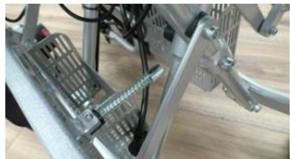
Das Einsetzen der Batterie in den T3 erfolgt in umgekehrter Reihenfolge. Batterie in das Fach schieben, verriegeln, danach anschließen.
