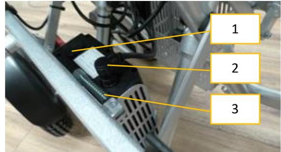
Die Batterie klemmen Sie ab, indem Sie den Schraubverschluss öffnen und den Stecker abziehen.
