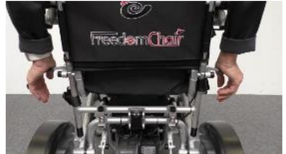
**ACHTUNG: Durch das Verstellen der Rückenlehne nach hinten ändert sich der Schwerpunkt des Rollstuhls. Beim Befahren von Steigungen könnte der Rollstuhl nach hinten kippen. Bitte stellen Sie die Rückenlehne in die Normalposition, wenn Sie Steigungen befahren. Wenn Sie nach hinten gelehnt fahren, können sie nicht auf den Weg vor ihnen sehen. Die Effekte werden durch die Montage der Kopfstütze nochmals verstärkt.**
