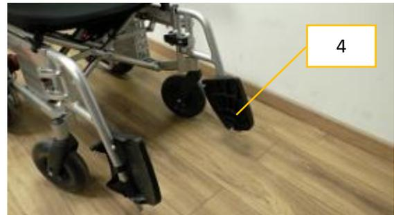
Zur Entriegelung der Fußstützen schwenken Sie den Hebel nach vorne.
