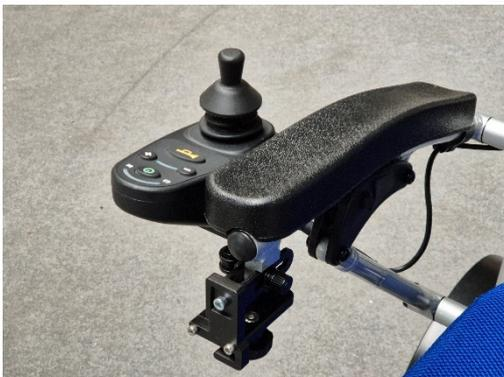
Um sehr nahe an einem Tisch heranzufahren, empfehlen wir den Schwenkarm komplett zu schwenken, sodass sich das Fahrpult seitlich der Armlehne befindet.
