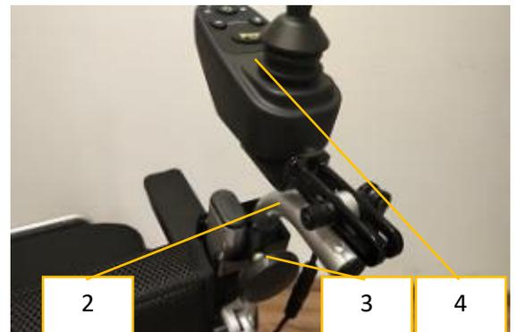
Das Verbindungselement auseinanderschrauben und links oder rechts auf den Rahmen der Rückenlehne schrauben. Das Rohrstück in das 2. Loch stecken und mit der Rändelschraube festziehen.
