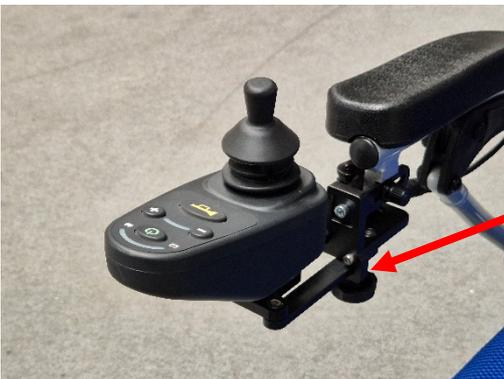
Lösen Sie die Fixierschraube unter dem Schwenkarm.
