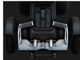
**Stabilisator:** Die Integration von Stabilisator und Einzelradaufhängung sorgt für unübertroffene Stabilität, insbesondere in engen Kurven.
