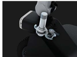
**Lenkwinkelsensor:** Eine Sicherheitsfunktion, welche die Geschwindigkeit beim Abbiegen automatisch anpasst, um ein optimales und sicheres Fahrerlebnis zu gewährleisten.
