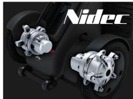
**Zweimotoriges System:** Die Motoren können sich in entgegengesetzte Richtungen drehen, sodass der Scooter auf der Stelle präzise Kurven fahren kann.
