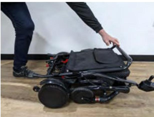
Drücken Sie die Rückenlehne nach unten in die umgeklappte Position.
