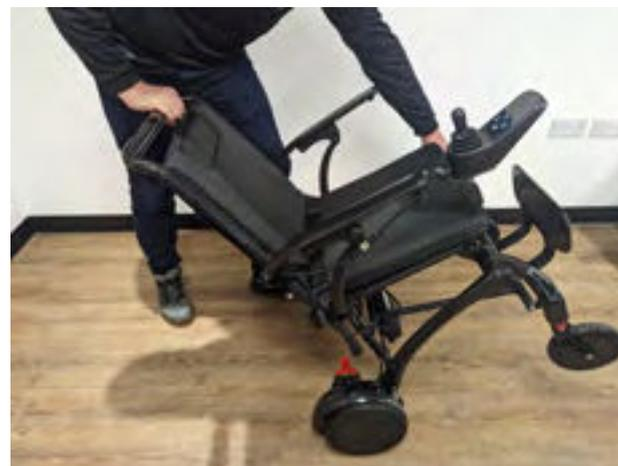
Drücken Sie so lange, bis Sie ein Klicken hören und der Stuhl sich in der geöffneten Position befindet.
