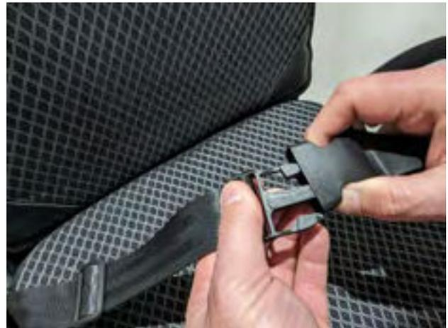
Öffnen Sie den Sicherheitsgurt, indem Sie die beiden Knöpfe auf beiden Seiten eindrücken.
