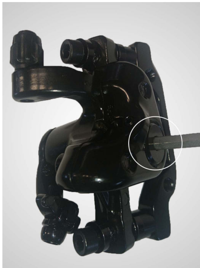
Abb. 48: Lösen des 5 mm Bremsbackenstellers
