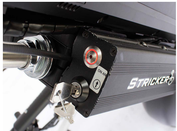
Abb. 41: Rückwärtsfahrleuchte an Steuerung leuchtet bei aktiviertem Rückwärtsgang
