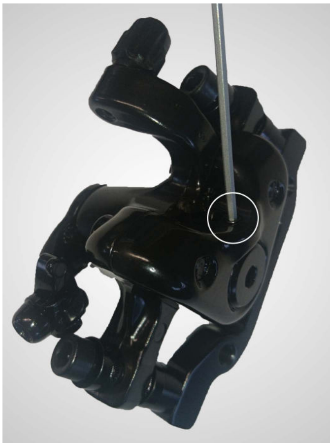
Abb. 47: Lösen der 2 mm Madenschraube
