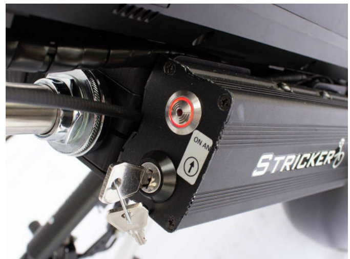
Abb. 41: Rückwärtsfahrleuchte an Steuerung leuchtet bei aktiviertem Rückwärtsgang
