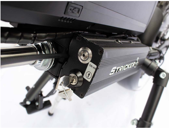
Abb. 34: Schlüsselschalter an Batterie und Steuerung
