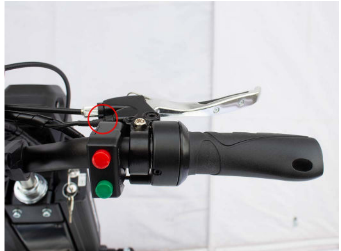
Abb. 42: Bremshebel mit Bremskontakt und Einleitung der Rekuperation (Unterbrecherkontakt ist nur am rechten Bremshebel angeschlossen.)
