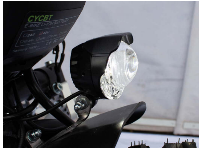
Abb. 40: Einstellung der Neigung der Lampe mit integrierter Hupe
