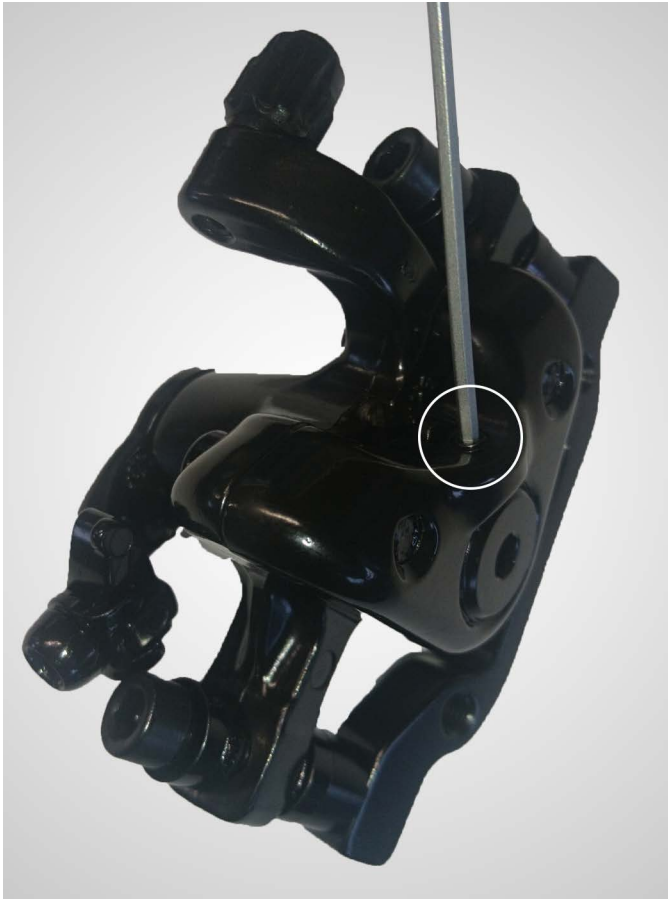
Abb. 47: Lösen der 2 mm Madenschraube
