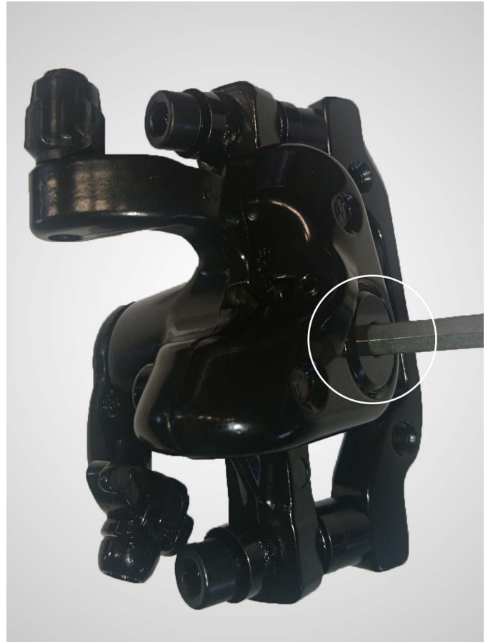
Abb. 48: Lösen des 5 mm Bremsbackenstellers
