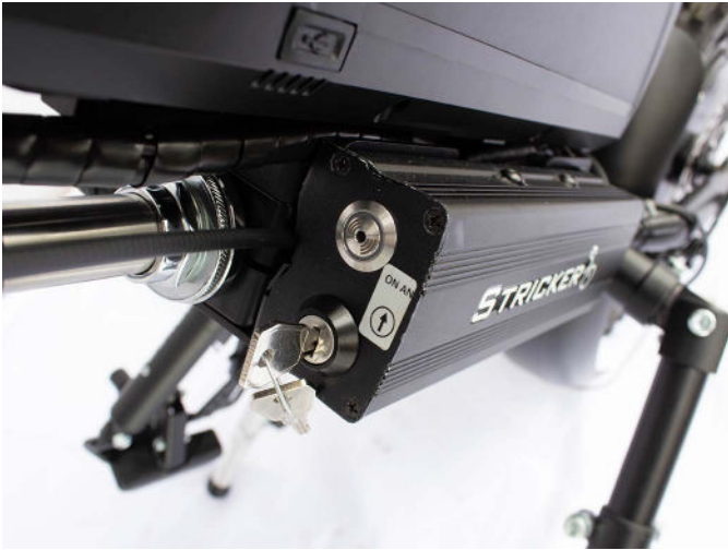
Abb. 34: Schlüsselschalter an Batterie und Steuerung
