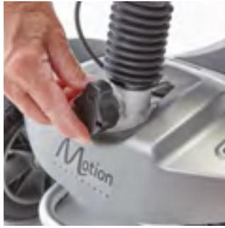
Entriegeln Sie die Lenksäule, indem Sie auf das Schloss drücken und es um 90 Grad gegen den Uhrzeigersinn drehen.
