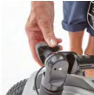
Wenn sich die Lenksäule in der gewünschten Position befindet, drehen Sie den Einstellknopf der Lenksäule im Uhrzeigersinn, bis er so fest wie möglich sitzt.
