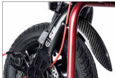
Carbon-Schutzblech Modernes Aussehen und geringes Gewicht
