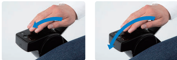
Kleiner Neigungswinkel = langsam Größerer Neigungswinkel = schnell
