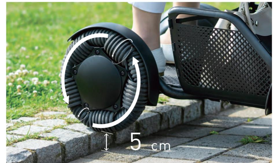
Überwinden Sie mühelos Hindernisse bis zu 5 cm Höhe dank zweier leistungsstarker Motoren und großer omnidirektionaler Vorderräder.
