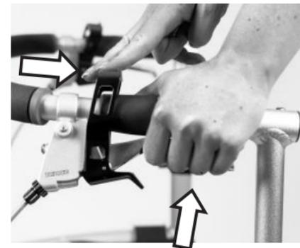
Option 3: Benutzen Sie beide Hände. Ziehen Sie den oberen roten Parkhebel nach hinten mit der einen Hand, während Sie gleichzeitig den Bremshebel mit der anderen Hand nach oben ziehen. Stellen Sie sicher dass die Parkbremse arretiert ist, und dass das Veloped sich nicht bewegt.
