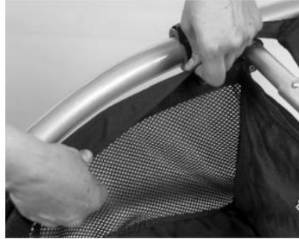
1. Führen Sie die hintere Klettverschlusslasche zwischen Rahmen und Korbschiene von unten ein. Schlagen Sie die Lasche nach innen um und befestigen Sie die Klettverschlüsse am Innenrand des Korbs.
