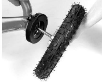
2. Überprüfen Sie, ob das Rad korrekt befestigt ist, indem Sie es seitwärts drücken/ziehen.
