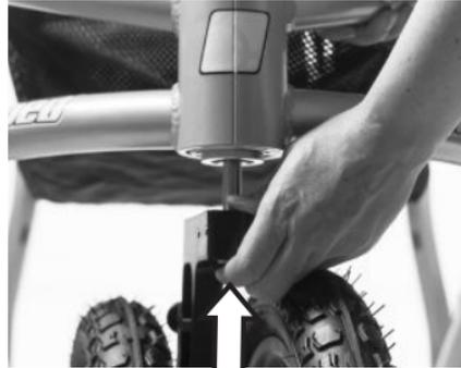
2. So entfernen Sie die gesamte Radaufhängung: Heben Sie die Vorderseite des Rahmens vom Boden ab und ziehen Sie gleichzeitig die Radaufhängung nach unten.
