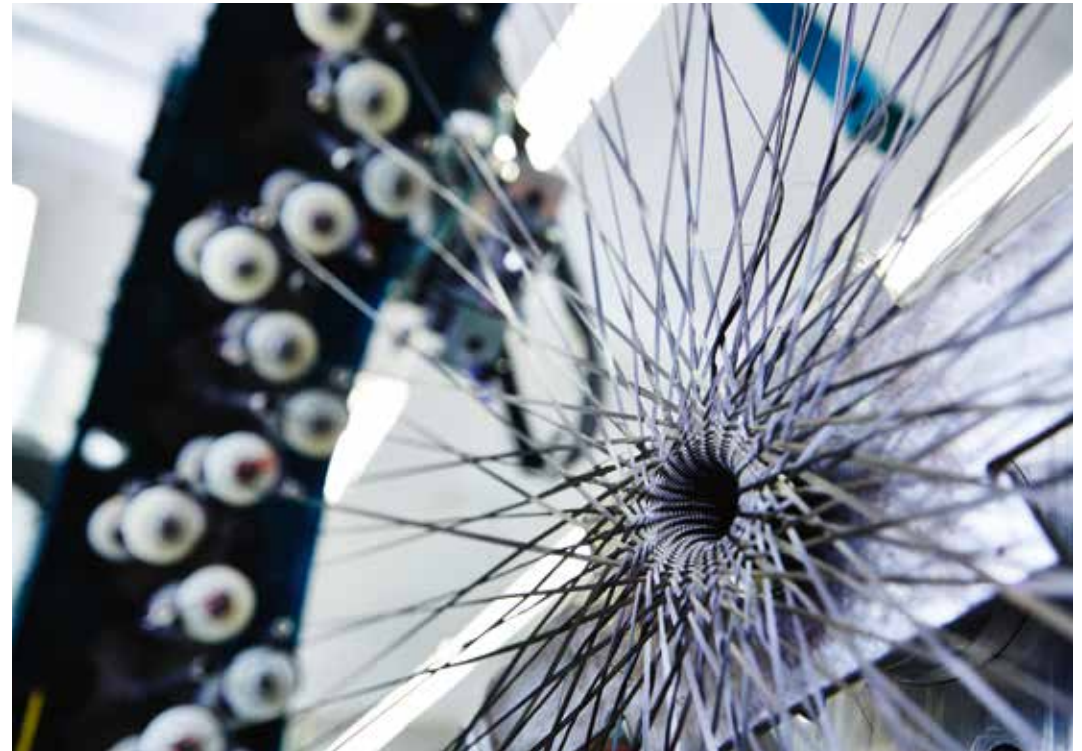
Robotergestütztes Flechten der Rahmenrohre aus Carbonfasern
