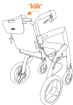
Abbildung 35: Klicken Sie die Rückenlehne in die Führungen
