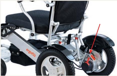
Abbildung 13: Position der Feststellbremsen
