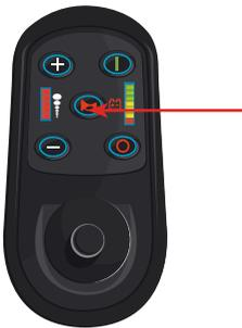
Abbildung 11: Taste „Hupe“ auf dem Bedienmodul“
