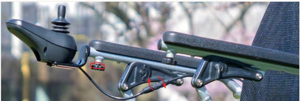
Abbildung 6: Das Bedienmodul fixieren und verbinden
